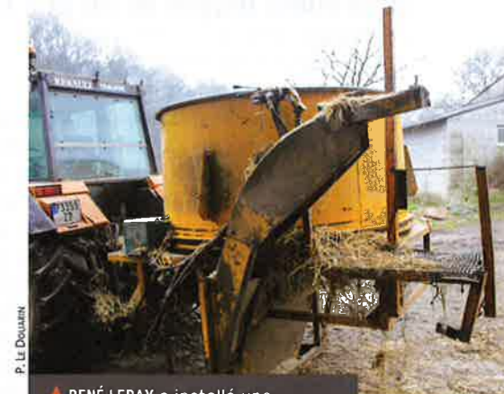
RENÉ LERAY a installé une plateforme à son bol hacheur Electra pour gagner en rapidité lors des chantiers toujours réalisés en poste fixe.
