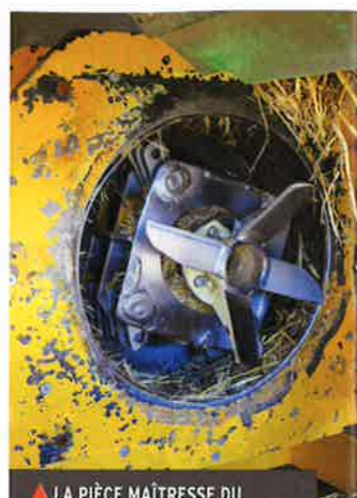
LA PIÈCE MAÎTRESSE DU BROYEUR ELECTRA tournant à 3000 tours à la minute est ce rotor équipé d'un pré-hacheur et de vingt-quatre marteaux.
