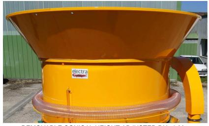
REMOVABLE CONICAL HEIGHT ADJUSTER DIA. 3 M FOR LOADING CUBIC BALES (OBLONG ON REQUEST)
