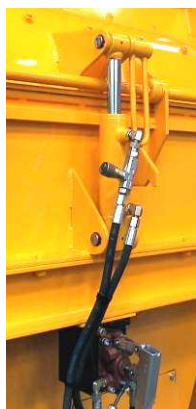
Système hydraulique d'ouverture du broyeur
