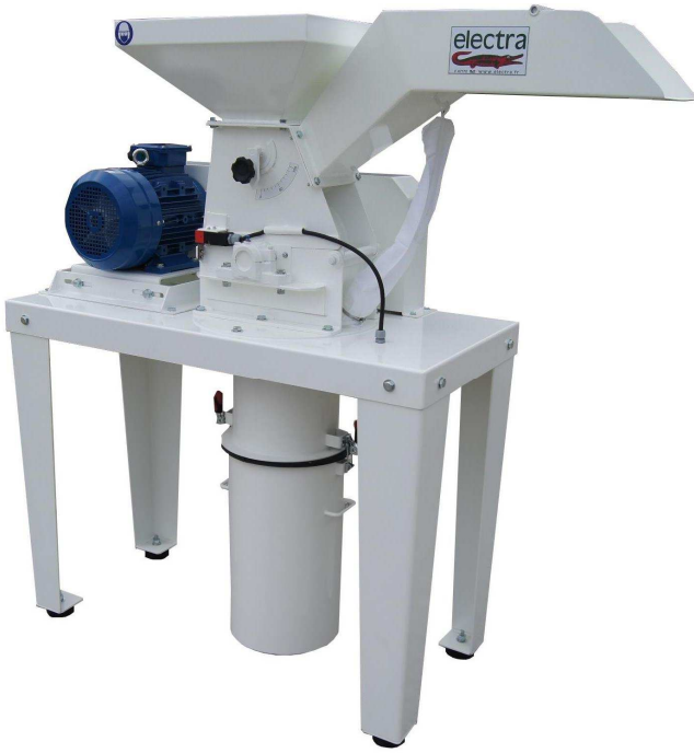
Broyeur avec seau de récupération, trémie et goulotte
